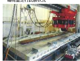
■道路橋示方書に示される階段状荷重の輪荷重走行試験状況
